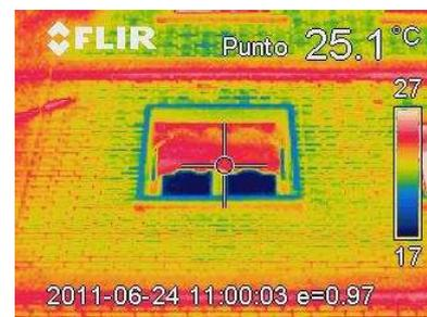
Figura 14 y 15. Termografías de la fachada de estudio del Edificio en la Calle Guisona 4. Elaboración propia. En las termografías podemos observar la diferencia de temperatura entre la fábrica y las llagas, esto nos indica una falta clara de aislamiento ya que si lo hubiese, pero no se tienen indicios de ningún puente térmico.
